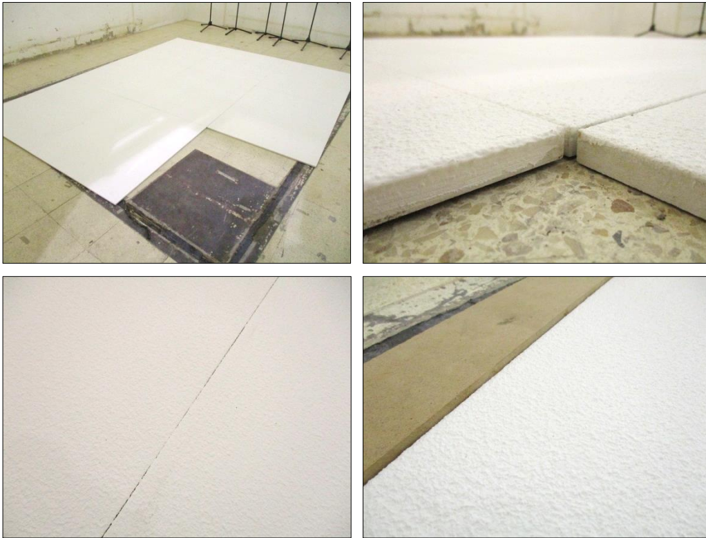
Imágenes 4 a 7 Instalación de la muestra en la sala reverberante
